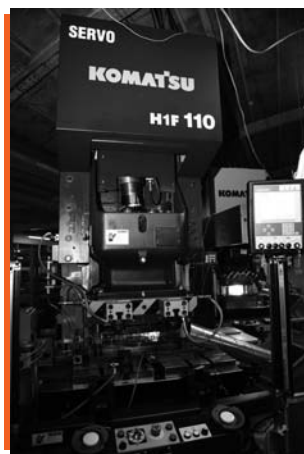
●コマツ新型サーボプレスH1F110-2 振子モーションを活用し、高効率な生産を行っている。
