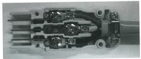
絶縁距離をとる工夫がなされた内部
